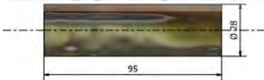
Gambar 4.2 Dimensi material setelah dipotong
