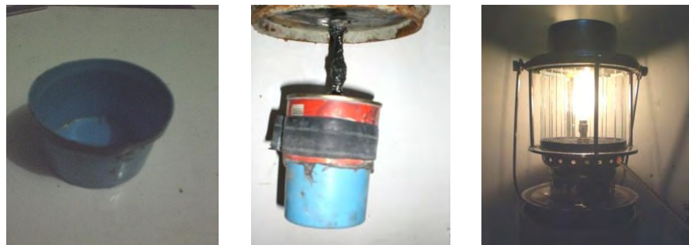
Gambar 4.2 Petromak menggunakan tabung plastik
