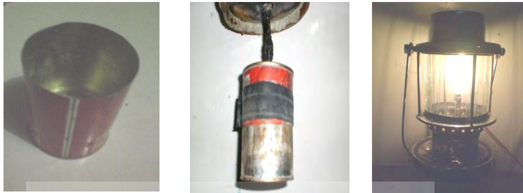
Gambar 4.1. Petromak menggunakan tabung kaleng.
