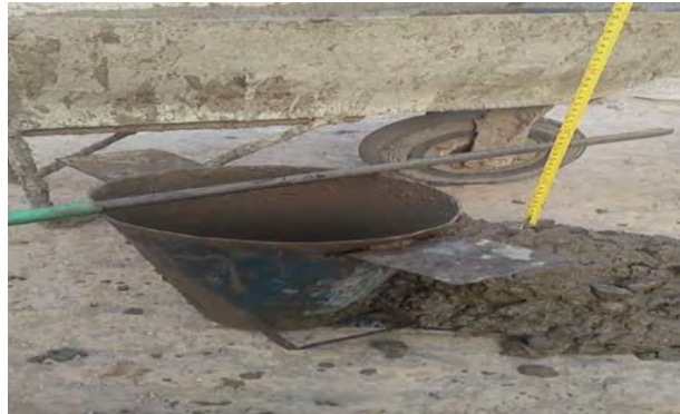
Gambar 6.3 Tes Slump Beton
