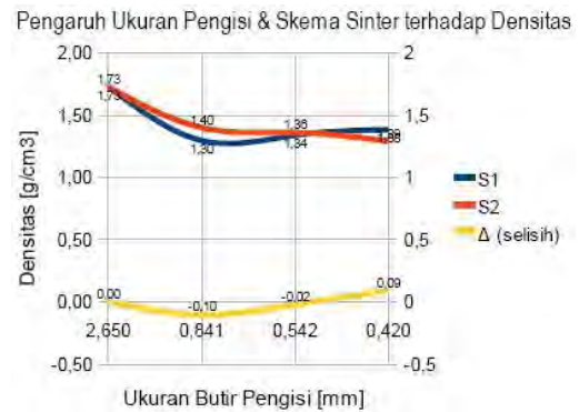
Gambar 4.5. Pengaruh ukuran pengisi terhadap Densitas logam busa.
