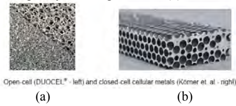
Gambar 2.1 Contoh sel terbuka (a), serta contoh sel tertutup (b) [4].
