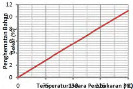
Gambar 10. Grafik pengaruh pemanasan udara terhadap penghematan bahan bakar
