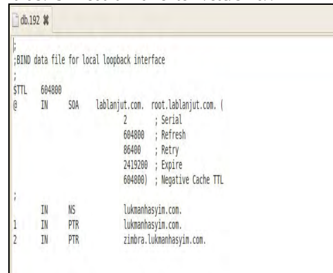
Gambar 21. Pengaturan zona domain Network DNS Server 192
