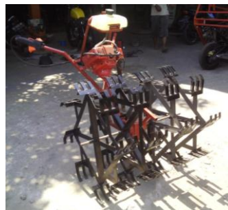
Gambar 3. Alat pengendalian gulma berpengerak motor yang perlu direkayasa agar lebih memenuhi harapan petani
