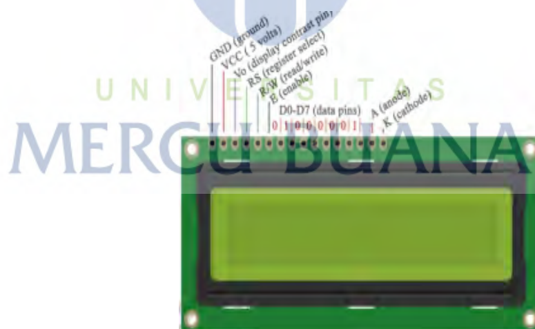
Gambar 2.4. Konfigurasi Pin LCD Karakter 16x2
