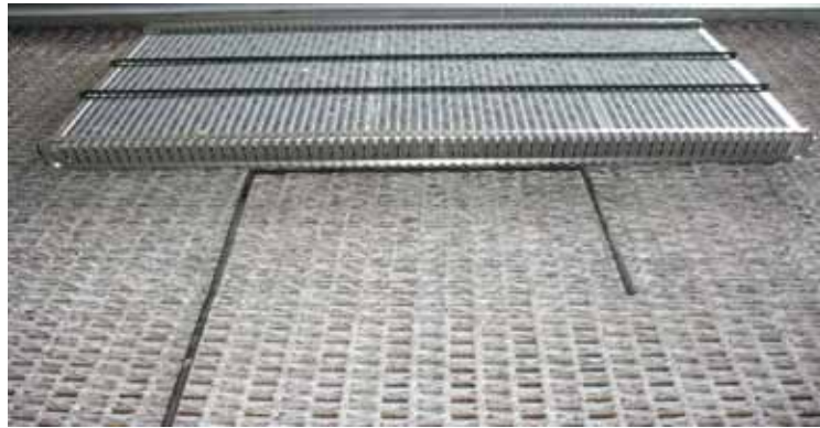
Gambar : 3.4. Penempatan tatakan core diatas tatakan pada konveyor mesin brazing
