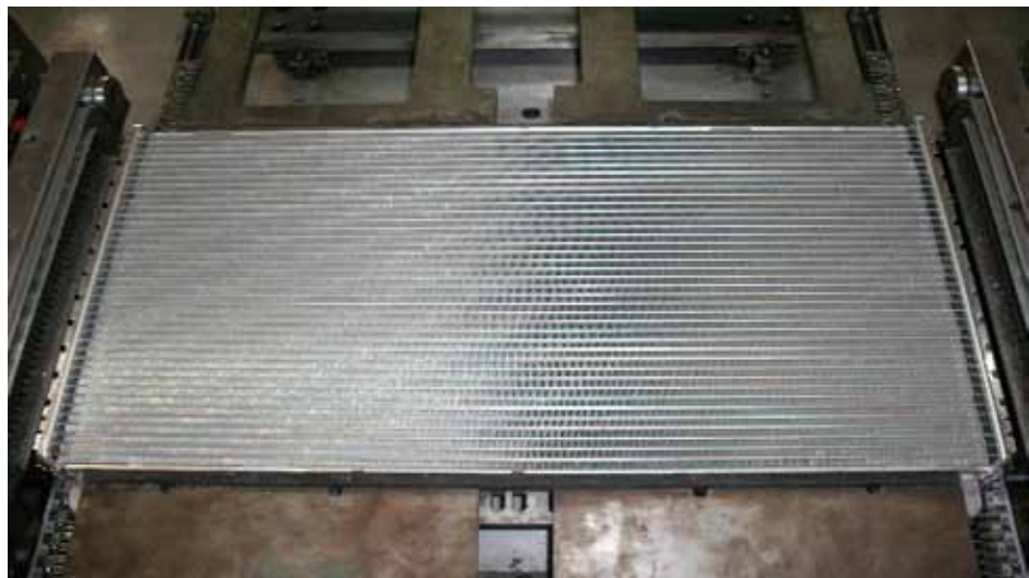
Gambar 3.1. Proses perakitan core
