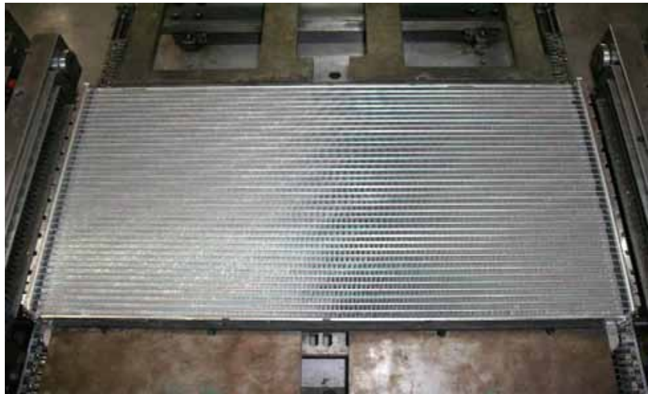
Gambar 2.10. Proses perakitan core
