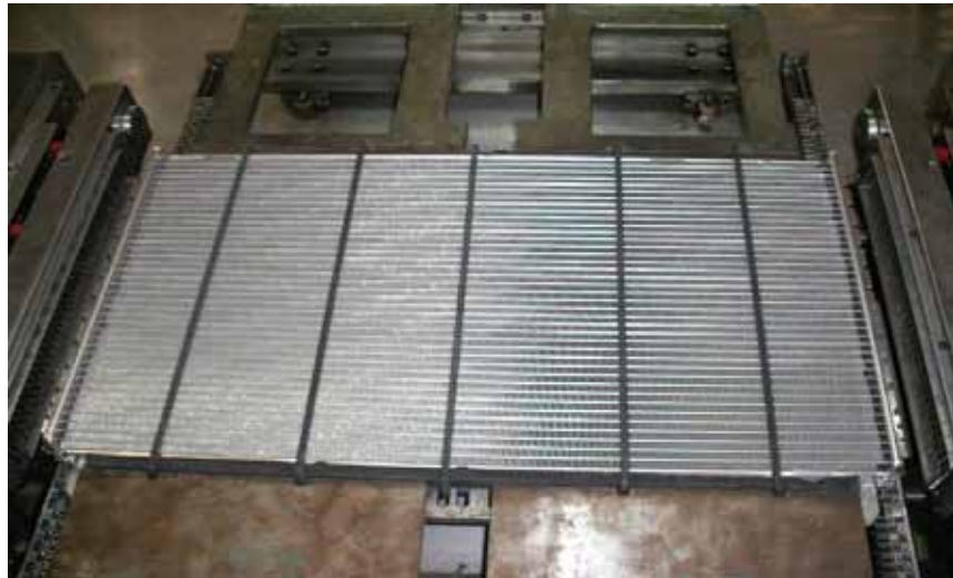
Gambar 4.0. Pemasangan jig pada coakan S/P Gripper
