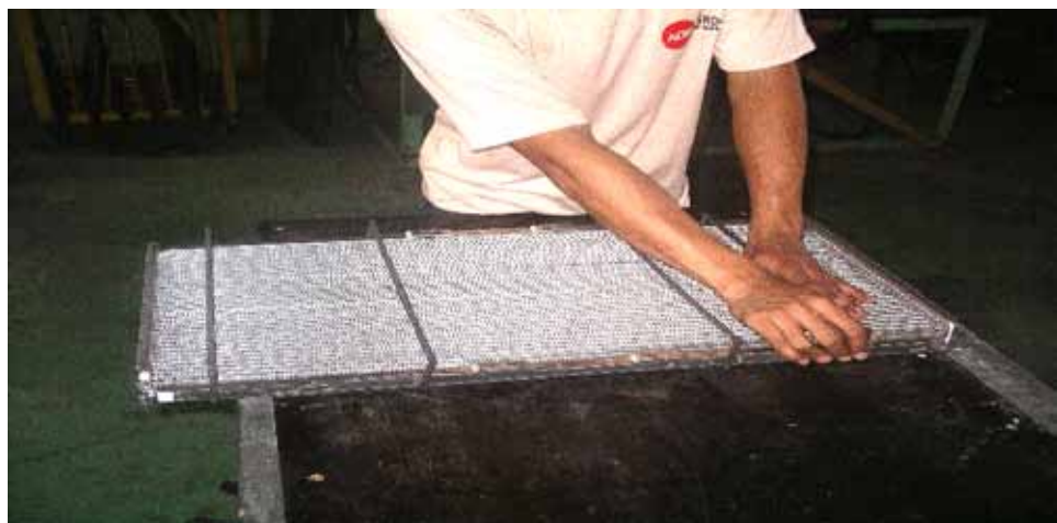
Gambar : 3.3. Proses Pemasangan Jig Secara Manual
