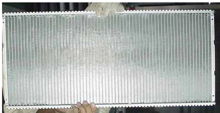
Gambar : 3.5. Core yang telah dibrazing
