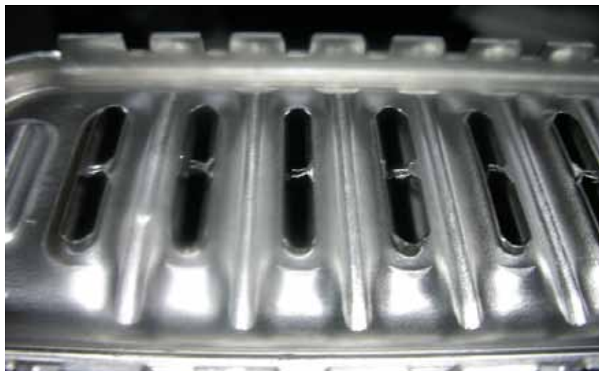
Gambar 2.11. Core yang diexpand
