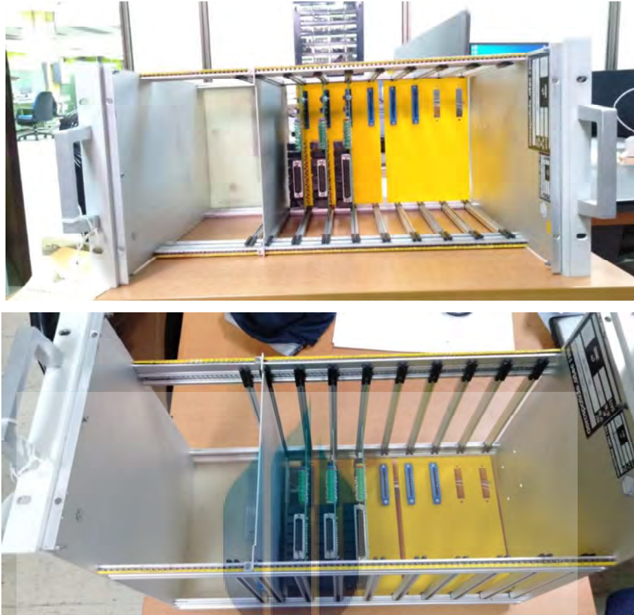
Gambar 4.3 Module PCB terpasang pada alat switching unit
