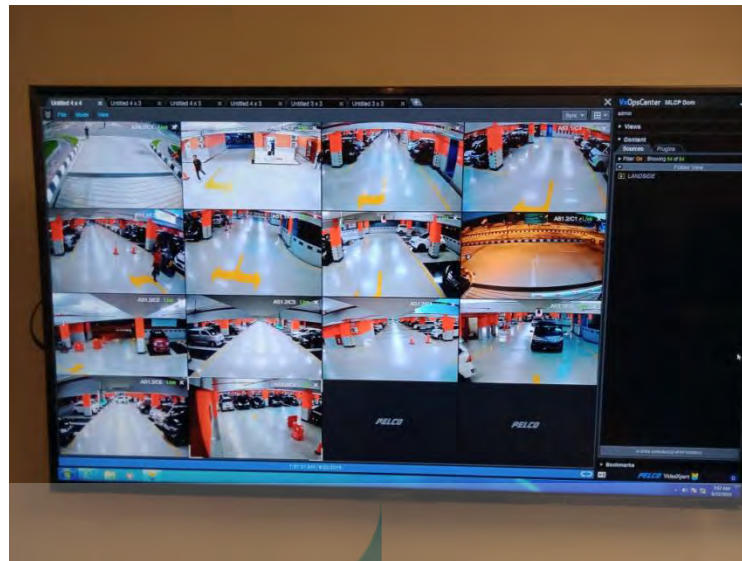
Gambar 4.3. Hasil kiriman gambar dari NVR ke monitor
