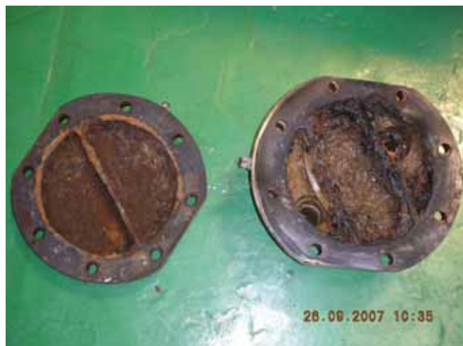
Gambar 4-3. Pengerakan pada stationary head dan rear head
