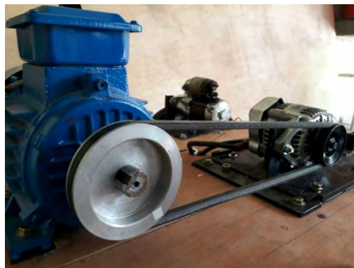
Gambar 3.4. Pemasangan Rangkaian Komponen
