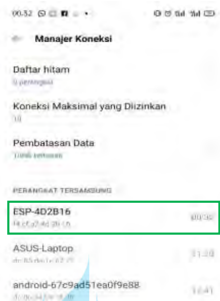
Gambar 4. 3 Nodemcu telah terhubung ke jaringan WiFi
