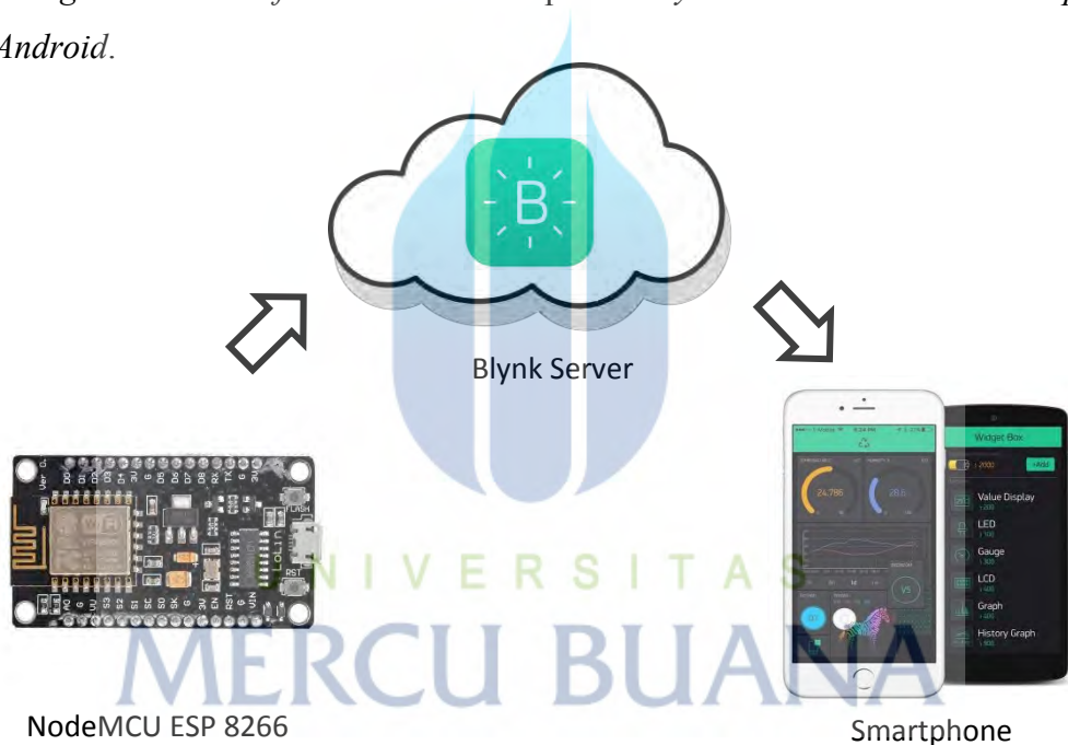
Gambar 3. 8 Koneksi NodeMCU dan Smartphone Android
