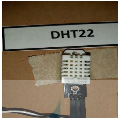
Gambar 3.4. Sensor Suhu dan Kelembaban DHT22
