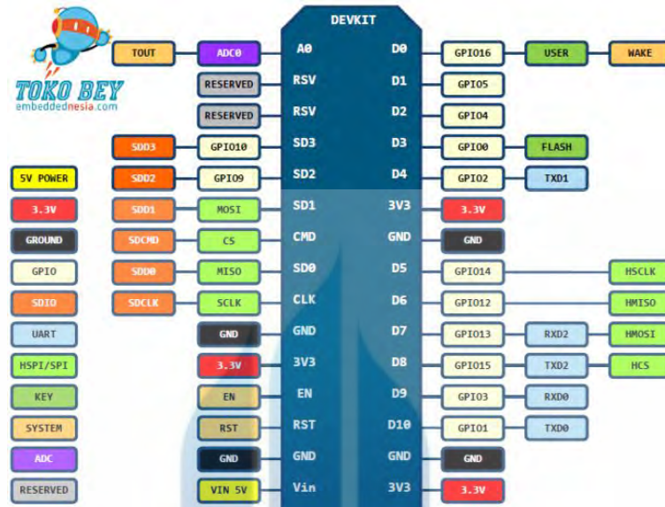
Gambar 2.15 Skematik posisi pin NodeMcu devkit v2 (Sumber : Fajar Wijaksono, 2017)
