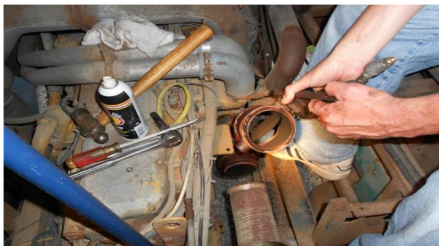
Gambar 4.8 Mengangkat Exhaust Brake Valve (Sumber: dokumen pribadi)
