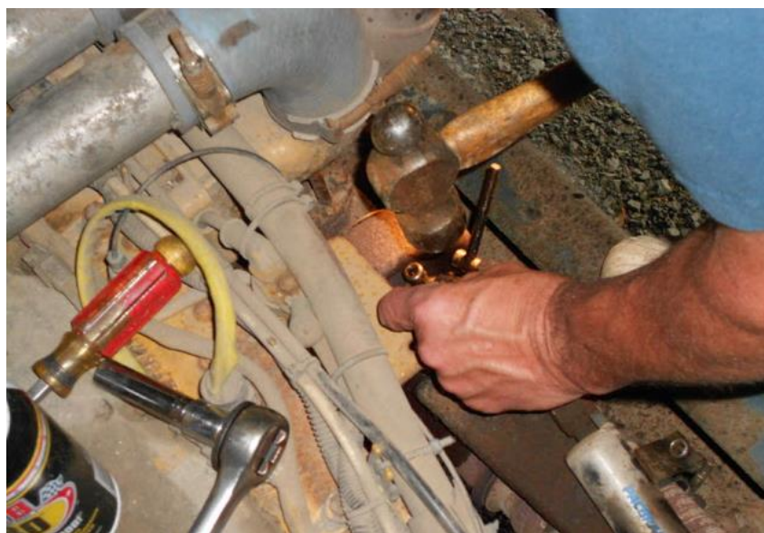
Gambar 4.7 Cara Melepas Exhaust Brake Valve dengan Palu (Sumber: dokumen pribadi)
