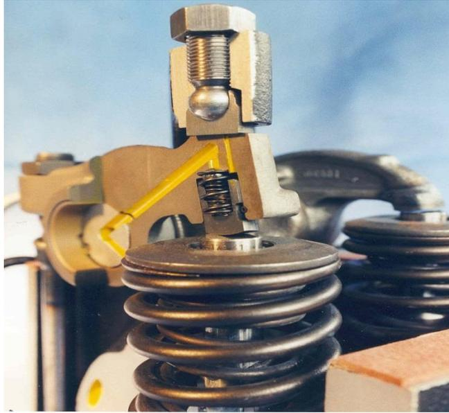
Gambar 3.12 Skema Saluran Oli *Engine Brake* pada Mesin CA6DM2
