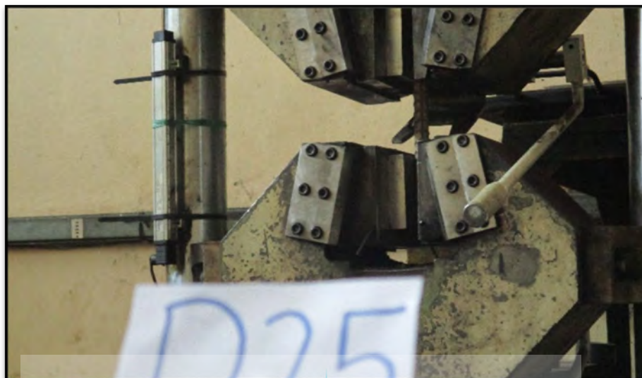
Gambar 6.7 Uji Tarik Baja D25
