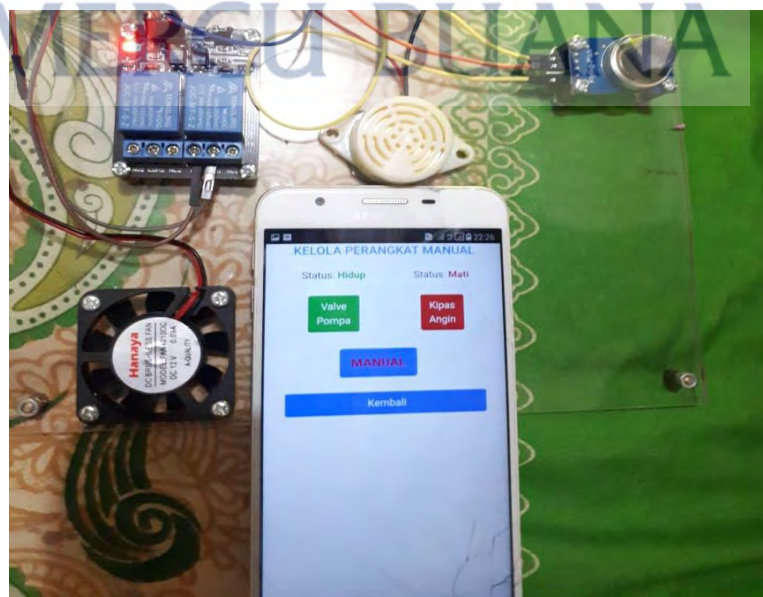
Gambar 4.14 pengoprasian valve secara manual
