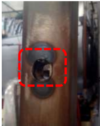
Gambar 4.11. Nut Problem Pada Siku Door Module ( Nut Spatter )
