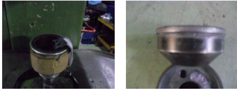
Gambar 4.10. Lifting pad bagian dari mesin seamer
