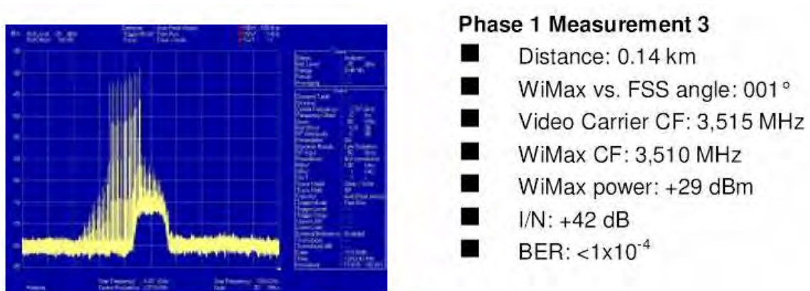
Gambar 3.23 Contoh hasil pengujian interferensi WiMAX-Satelit
