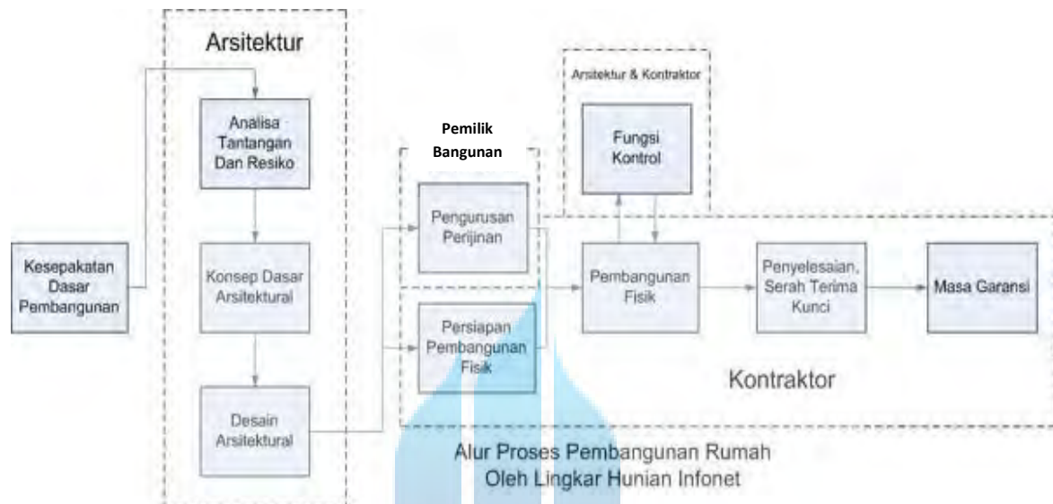
Gambar 2.10. Tahapan – Tahapan Pembangunan
