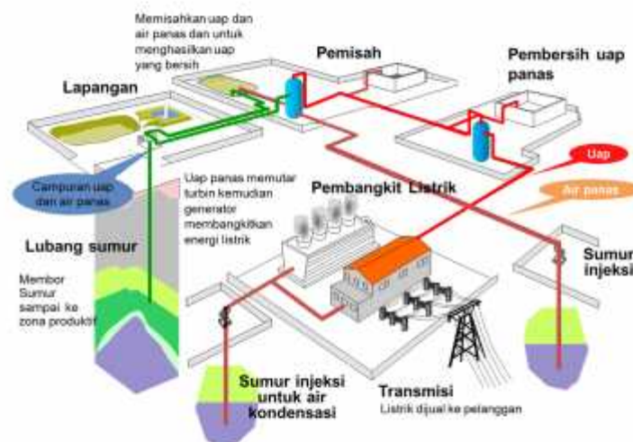
Gambar 3.3. Siklus Pembangkit Listrik Panas Bumi dengan Tipe Wet Steam
