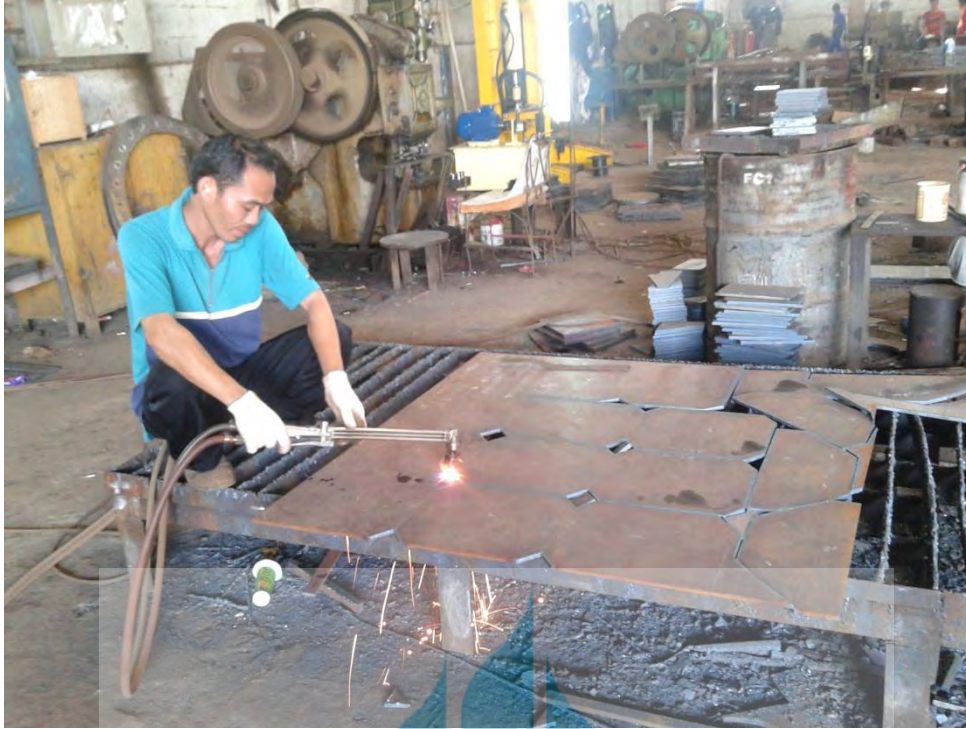
Gambar 3. 8 Pemotongan dengan las potong
