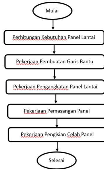
Gambar 2. 9 Bagan Alir Metode Panel Lantai Beton Ringan Bertulang
