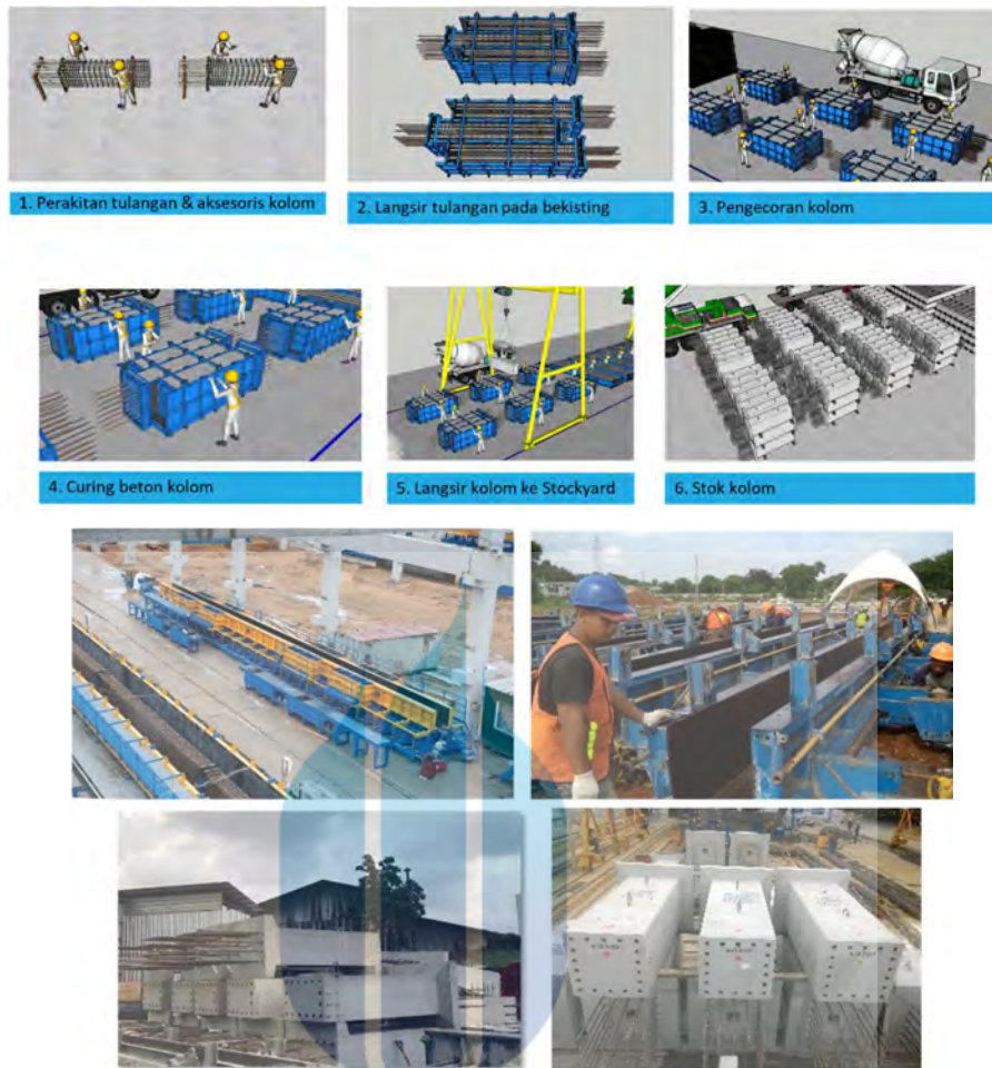
Gambar 3. 12 Ilustrasi proses tahapan produksi struktur kolom pracetak
